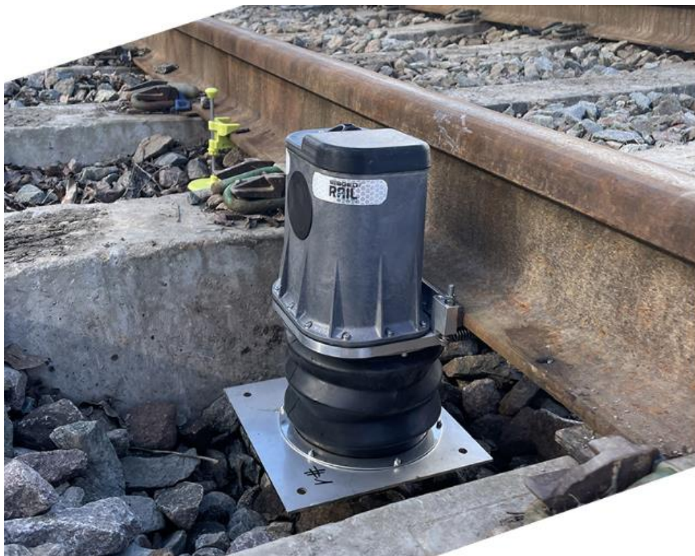
Obrázek 2 - foto zařízení pro měření kolejnic/pražců
